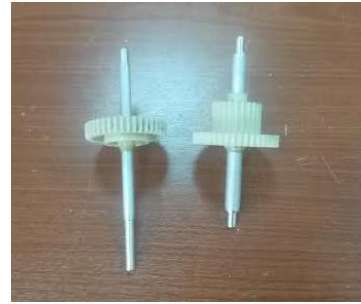
Şekil 3: Mekanizmada kullanılan plastik dişliler
