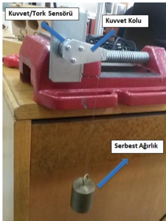
Şekil 4: Kuvvet/tork sensörü ölçüm hassasiyeti testi
